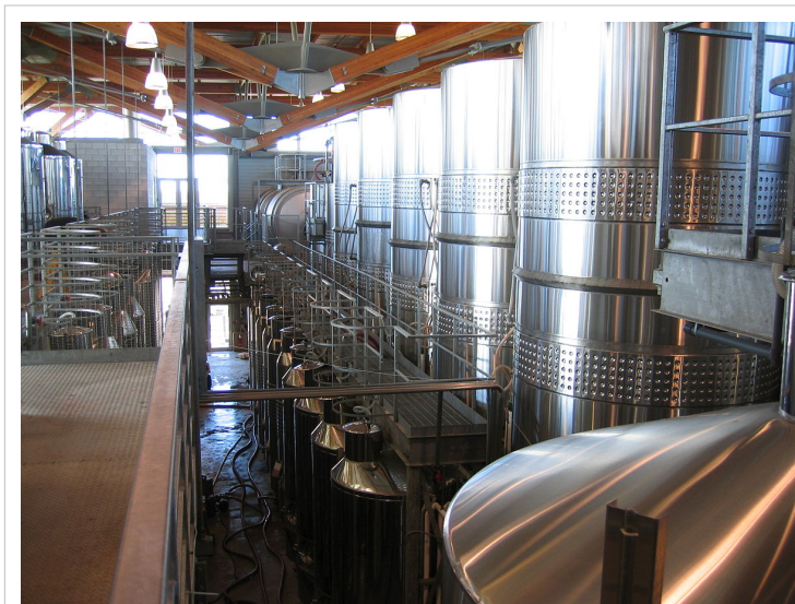
Cubas metálicas de acero inoxidable empleadas en la fermentación industrial del vino
